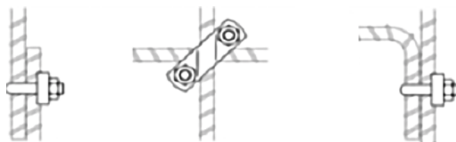
Obrázek E.5b – Svorníkové spoje podle EN 50164 (vhodné pro bleskové proudy)
