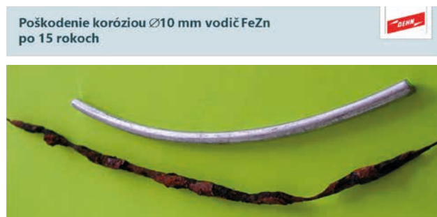
Obr. Koróziou poškodený vodič po 15 rokoch od inštalácie
